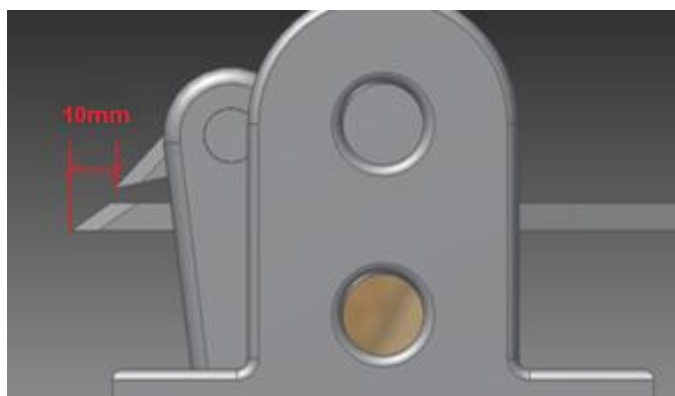
Figura 23 - Defasagem das lâminas
