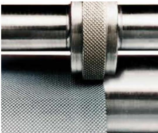
Figura 9 - Processo de fabricação mecânico do rolo Anilox
