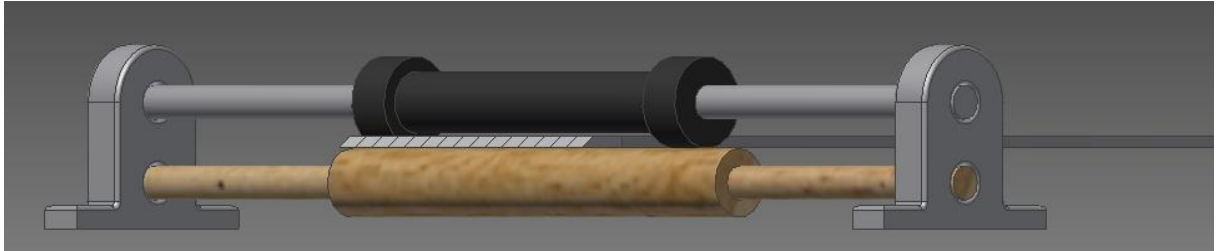
Figura 17 - Rolos puxadores e faca inferior
